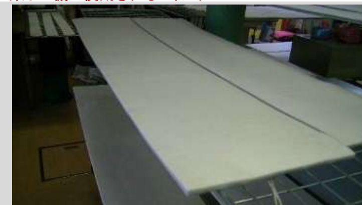
テンションパッド 鉄をリールに巻き取る際、油を取り、シワが起きないように軽く抵抗を掛けるパッド
