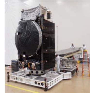
JCSAT-RAのアンテナ取付け
