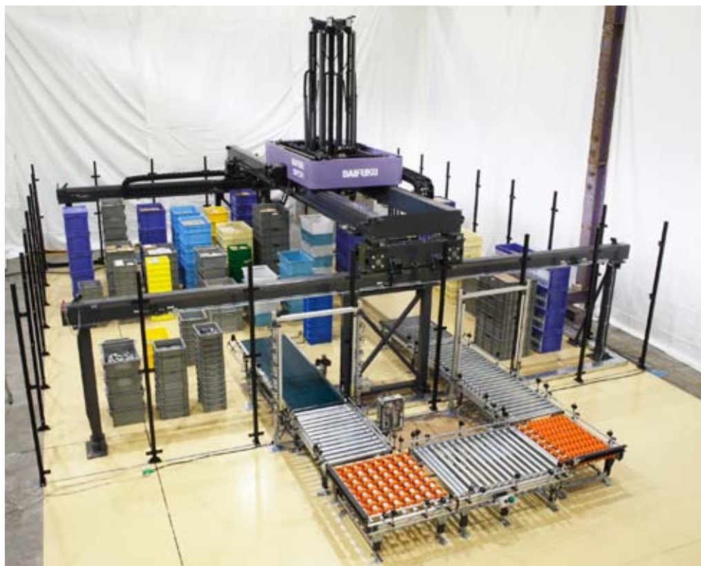
平置き・段積み保管した多様なケースを仕分ける
