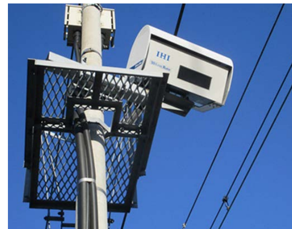
3次元レーザーレーダ式踏切障害物検知装置
