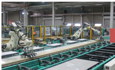
ロボットアームで耐火材を配置
