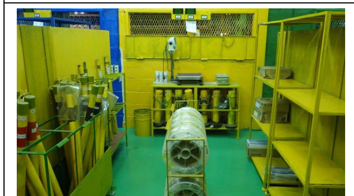
溶材管理室内の管理区分 (溶材種別に色識別) : P5
