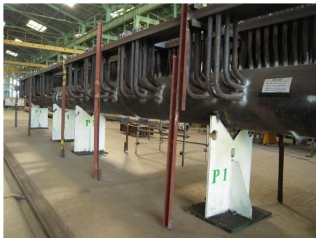
架台による製品母材の色識別
