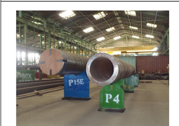
素材(大口径管)に対する色識別
