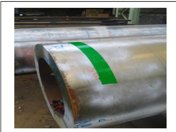
素材(大口径管)に対する色識別
