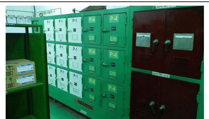
被覆アーク溶接棒の乾燥炉の色識別
