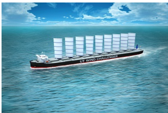
ウインドチャレンジャー （伸縮式の硬翼帆を備えた船舶）
