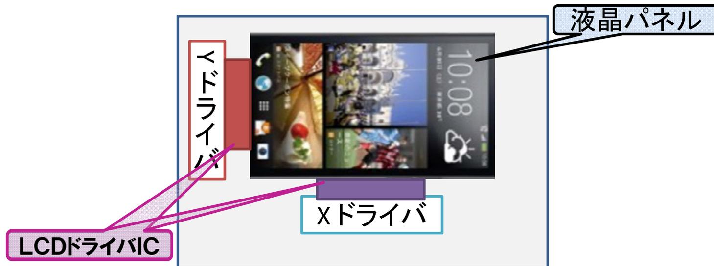
X(横方向)及びY(縦方向)ドライバと示したのがLCDドライバICです。
