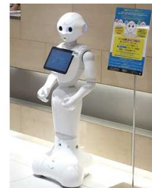
インフォメーション業務をサポートしている感情認識ヒューマノイドロボット「Pepper」
