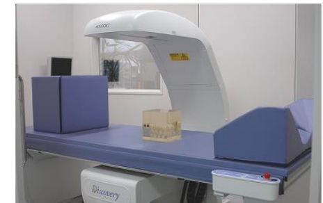
X線吸収を利用した骨密度測定装置(DEXA)
