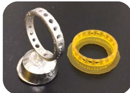
UV硬化3D造形材料開発品による造形物
