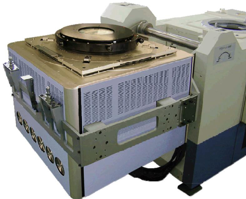
当装置は、最新のアーキテクチャを用いて設計された検査装置で、LCD ドライバIC用途に最適化することで、高速、省スペース、低価格を実現しました。また、オプションの機能を加えることで、電流出力タイプの有機ELドライバICにも対応します。
