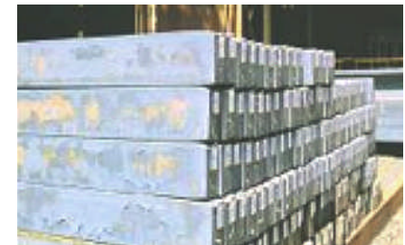
ビレット (型鋼、平鋼、棒鋼等素材)
