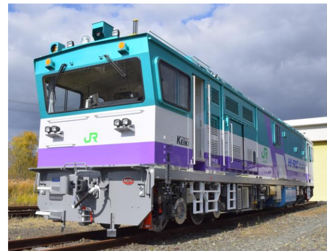
新型超音波レール探傷車 (JR北海道に納入)
