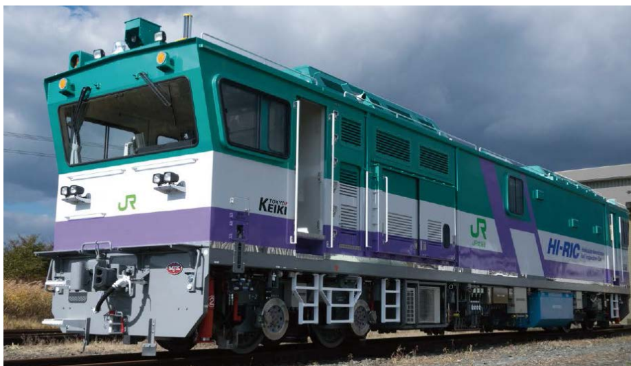
超音波レール探傷車（JR 北海道殿） （東京計器レールテクノ（株）製）
