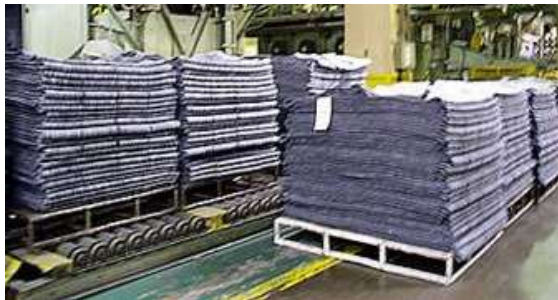
タイヤの製造工程でゴムを一定期間 保管する際に防着剤を使用
