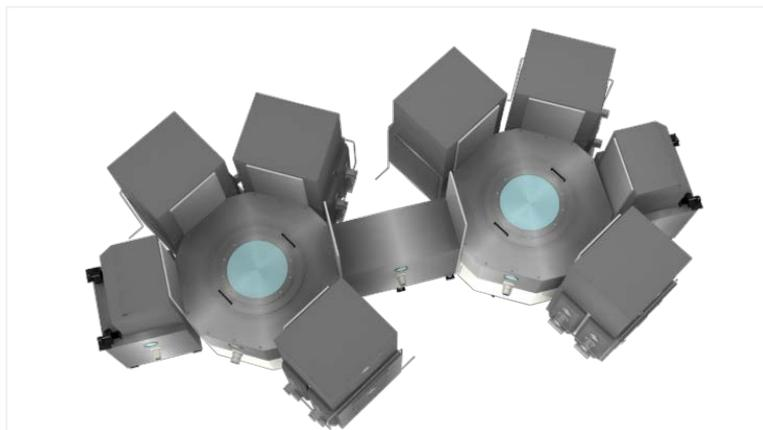
縦型蒸着装置（コンセプトイメージ）
