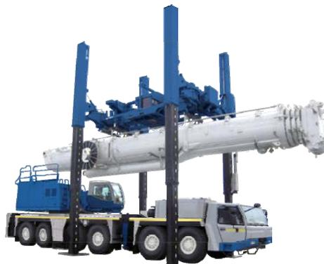
オールテレーンクレーンATF400Gのboom着脱作業例
