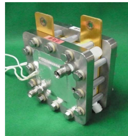
水電解セル サイズ:110×110×72mm 約3kg
