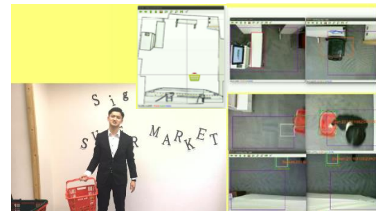
天井に設置されたカメラを用いてカゴ(人、カート)を追跡
