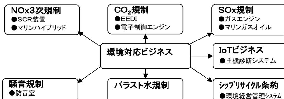
当社が現在取組んでいる環境技術には、①窒素酸化物の3次規制に対応するための、「選択式触媒還元脱硝装置」や電気モーターをディーゼルエンジンと組合せた「マリンハイブリッドシステム」、②硫黄酸化物規制に対応するための、クリーン燃料であるLNGを燃料とする「ガスエンジン」や硫黄分が規制値よりも低いMGOを燃料とするマリンガスオイル専焼機関、③乗組員の船内生活環境を改善するための防音室等の船内騒音規制対応商品の開発、④エンジンの不具合の未然防止や不具合発生の場合の原因究明をスムーズに行うためのリモートコントロール技術、⑤CO<sub>2</sub>削減のための燃費性能の優れた小型機関のラインナップ充実化や船舶におけるエンジンの運転領域に応じて燃焼改善を行う装置、等があります。
