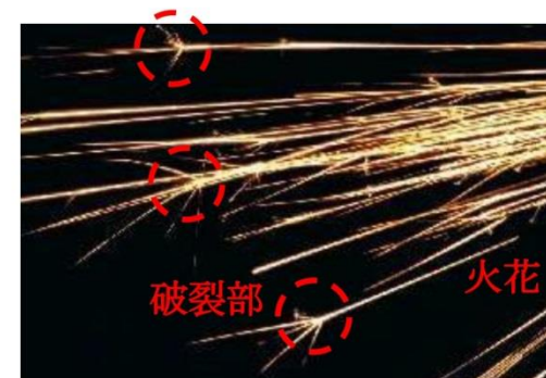
火花および破裂部の例
