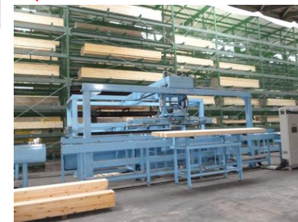
【出庫仕分け(ピッキング)機】
