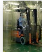
工場内の間仕切りカーテン
