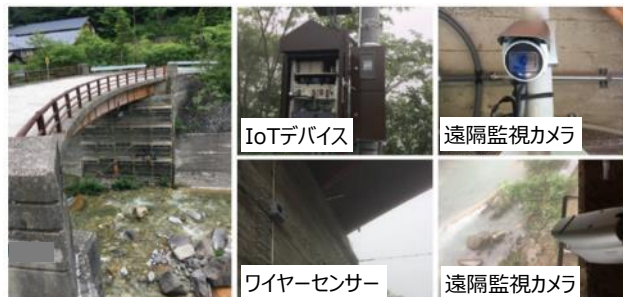
協業による防災IoTソリューション提供（土石流監視・監視）
