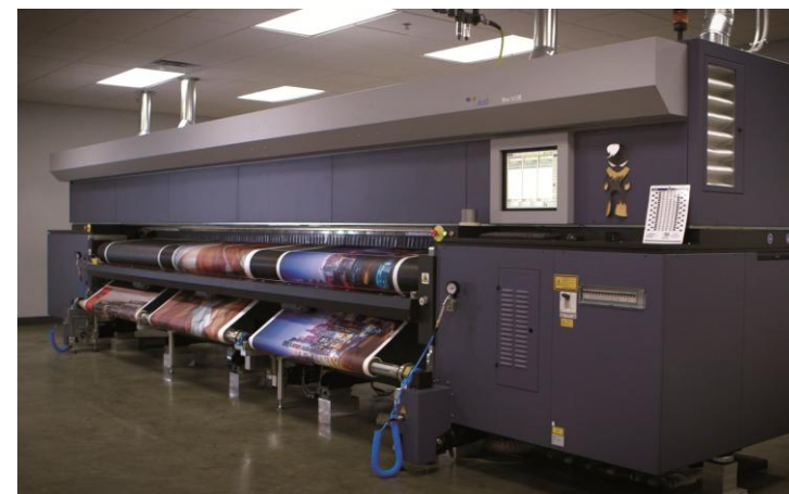
米国 Koroseal社 Louisville工場に導入したデジタル印刷機 壁装材の大判デジタルプリントは、商業インテリア デザイン市場における成長分野のひとつ
