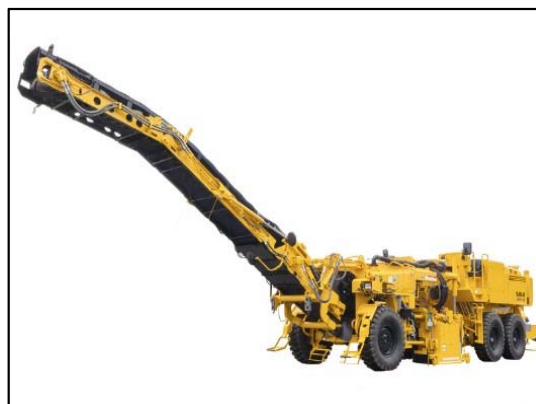
ロードカッター路面切削機
