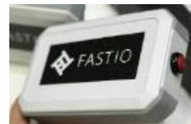
LoRa対応の傾斜センサーで、地滑りの恐れがある箇所、建設現場の仮囲い鋼板等に設置し、傾きを検知した際に通知が可能
