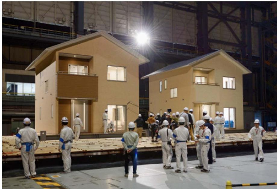
世界最大級の耐震実験施設「E-ディフェンス」にて連続加振実験を実施。複数回の震度7クラスの地震に対して当社標準仕様の住宅が高い耐震性能を有していることを実証
