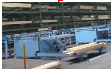
【仕向先 (邸) 別出庫台】 中央の仕分機より仕向先 (邸) 別に 木材が荷揃え出庫 ⇒出庫木材は新式プレカット加工 ラインへ投入
