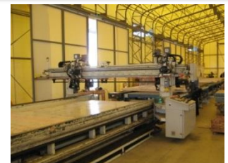
パネルシージングライン (自動釘打ちマシーン)
