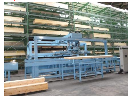
【出庫仕分け(ピッキング)機】 自動倉庫から送られてきた木材を 吸着式ピッキングマシンにより、 左右4台 (計8台) の仕向先 (邸) 別出庫台へ送る
