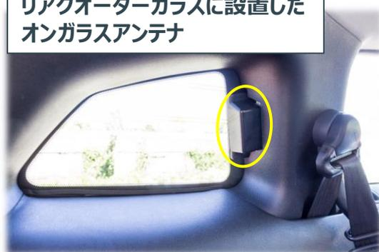
※28GHz帯対応オンガラスアンテナで以下を達成
