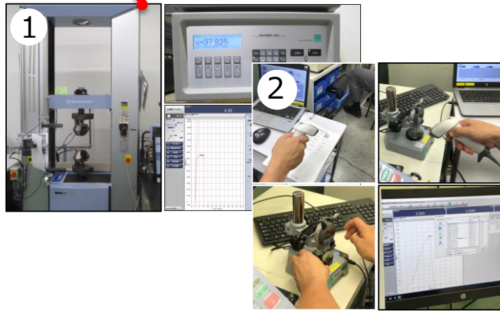
C-1) 自動化対応機器の導入(既設機改造を含む) C-2) 入力・転記レス化と測定値の自動転送
