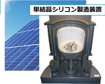
ホットプレス用鑄型 (カットモデル)
