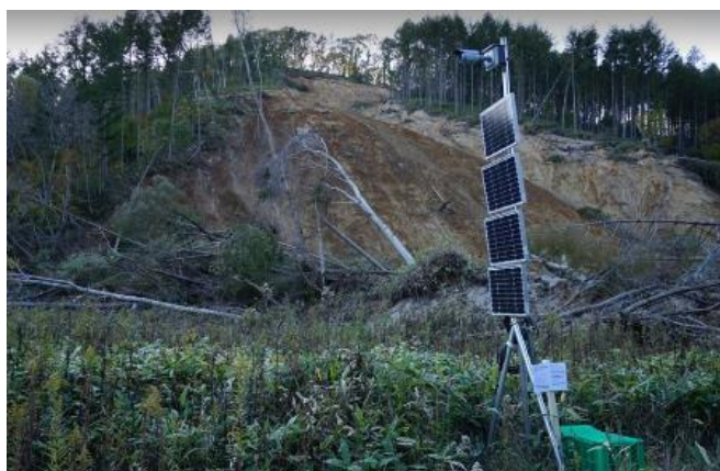
ソーラー電源、モバイル回線を利用するため、電源、通信回線がない場所でも設置可能
