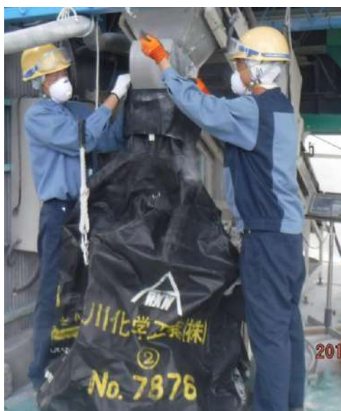
図 45 充填操作の状況（類似設備を使用して再現）
