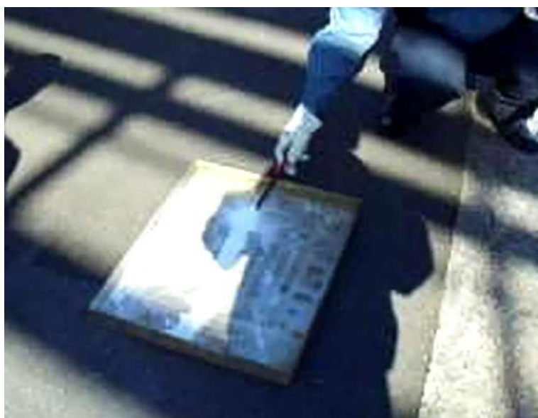
図 68 樹脂粉への着火テストの様子
