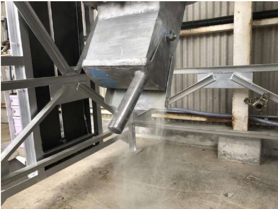
図 59 再現実験における回転型スライド弁の状況
