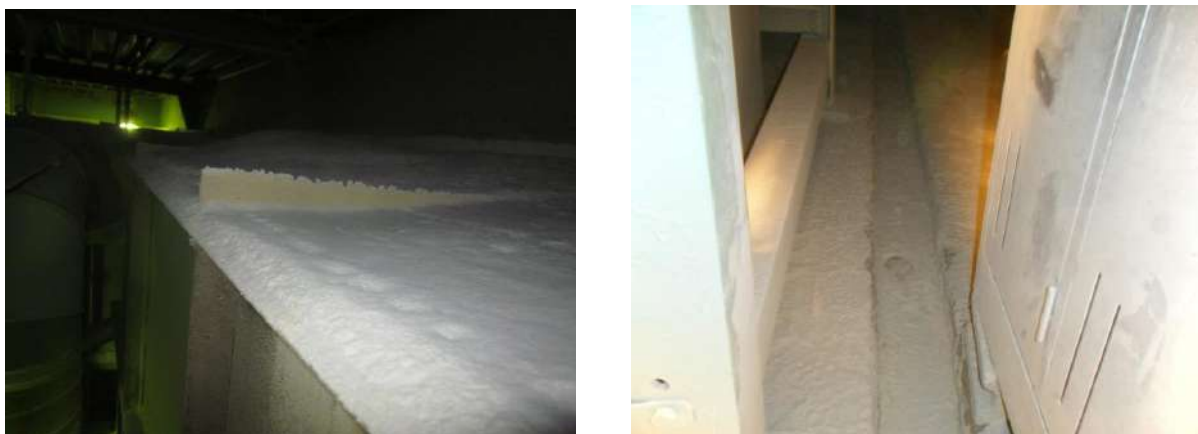
図 54 ロジン変性フェノール樹脂の包装作業場周辺の粉じん堆積状態（2016 年 11 月撮影） （左：ホッパー上の粉じん 右：タンク間の床の粉じん）
