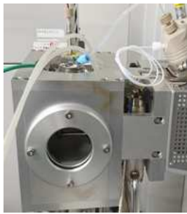
HMTの特許技術「イオン源アダプタ」 日本特許6106864号、国際特許出願中 (PCT/JP2017/012095)
