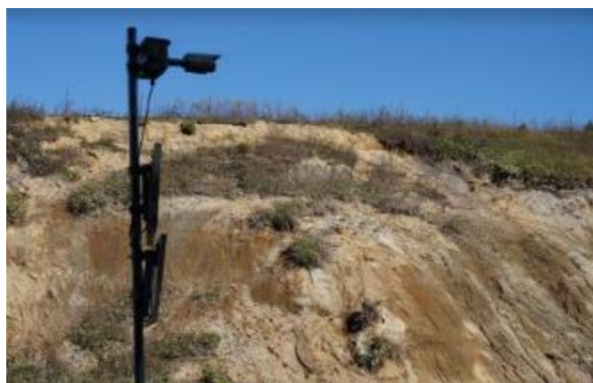
ソーラー電源、モバイル回線を利用するため、電源、通信回線がない場所でも設置可能
