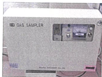
吸引式ガス漏えい検知警報器の構造例 (型式: SH-2703)
