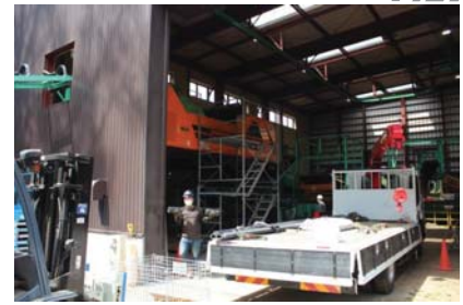
破碎処理棟 (前処理棟から運ばれてきた木くずを用途別の大きさに分けて破碎)
