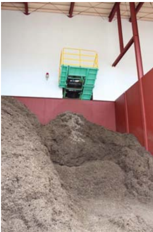
破碎された木質チップは、 破碎処理棟外側のヤードにて貯留
