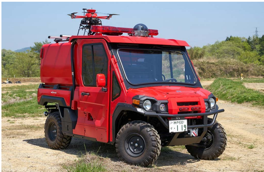
小型オフロード消防車 Red Ladybug (当社の MULE PRO-FX EPSがベース車両)
