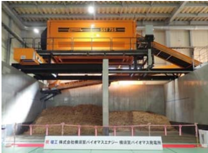
トロンメル式篩い機及び破碎機 (いずれもドイツ・ドップシュタット社製)
