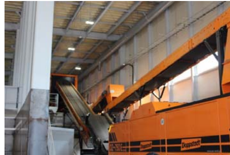
トロンメル式篩い機及び破碎機 (いずれもドイツ・ドップシュタット社製)
