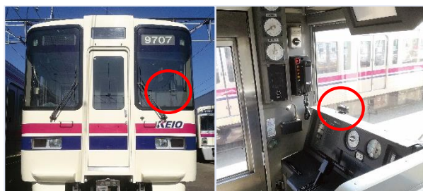
前方監視カメラの整備
