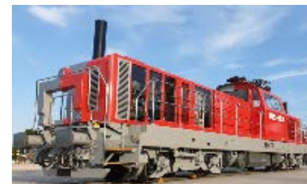
欧州規格対応ハイブリッド入換機関車 (SCiB™、PMSMを組み合わせた駆動システム)
