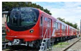
東京メトロ丸ノ内線向け All SiCインバータ・全閉PMSM、SCiB™を組み合わせた駆動システム
