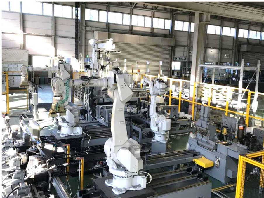
いわき工場 フープ筋の自動化ラインの例
