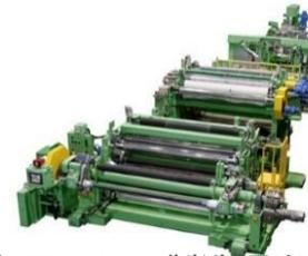
シートフィルム製造押出成形機
