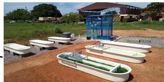
現地培養データを取得するための培養槽
