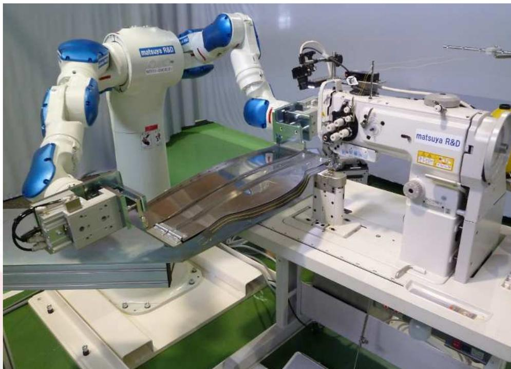
6軸ロボット3D2本針縫 縫製システム
