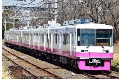
新型VVVFインバータ装置により 現行の8800形と比較し使用電力量約35%削減
