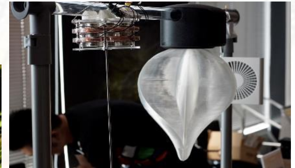
GUGEN2019の大賞作品"Planter"。家庭向け小型風力タービンで、SDGsのエネルギー枯渇問題への意識付けを目指すデバイス。
