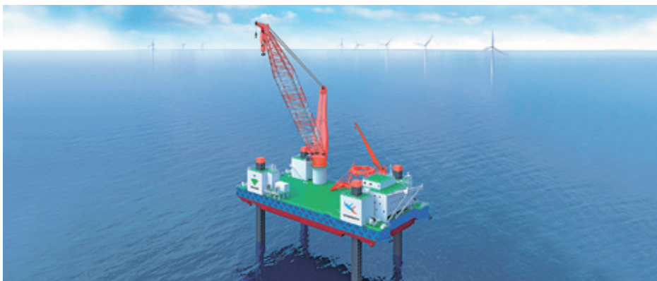
大林組と共同で大型洋上風力発電所の建設を目的とした SEP を建造中
