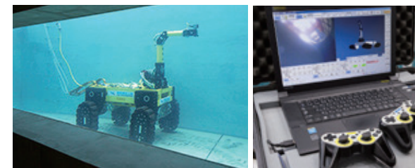
施工実験水槽におけるDEEP CRAWLERの操作性確認
