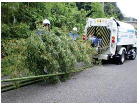
伐ったままではこのように長くて大きな竹も、キューティックに投入すればその場でチップ化できます
